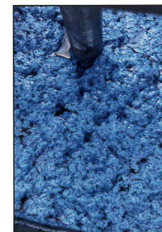
製紙工場余剰汚泥 (凝縮フロック)
